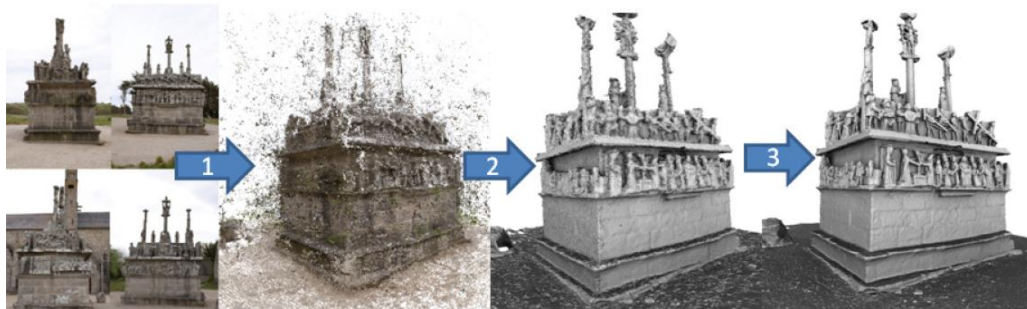
Figure 30: 3D Reconstruction pipeline. 1) Point cloud generation from multiple images; 2) Raw mesh; 3) Refined mesh (Credentials: Vu, Hong-Hiep, Stéréo multi-vues à grande échelle et de haute qualité , 2011)
